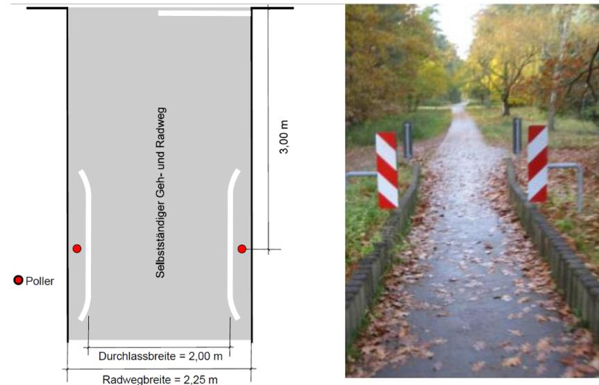
Abbildung 7: Systemskizze und Beispielbild einer seitlichen Einengung
